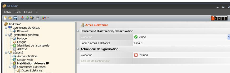
L'état de la connexion peut être visualisé par allumage d'un indicateur lumineux commandé par un actionneur du système Automation; la configuration de ce dispositif doit être indiquée en définissant les paramètres dans la case:
